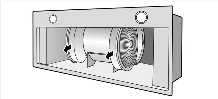
3. Spostare il filtro a carbone attivo a lato del motore.
