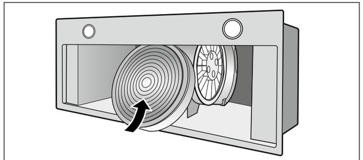
2. Spostare il filtro a carbone attivo a lato del motore.
